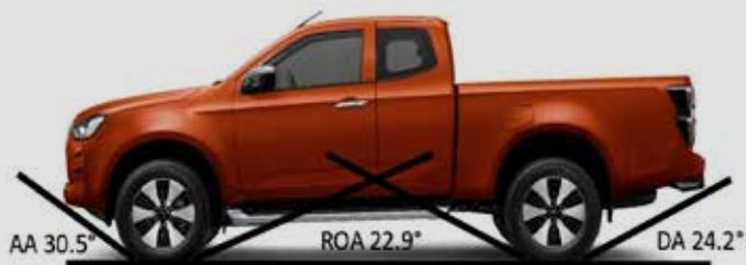
Die Böschungswinkel vorne und hinten wurden signifikant verbessert, dies auch Dank den in der Karosserie integrierten Stossstangen.
