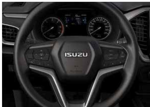
Elektrische Servolenkung. Geschwindigkeitsoptimiert, heisst leichte Steuerung bei tiefer Geschwindigkeit und straffere Steuerung bei hoher Geschwindigkeit.
