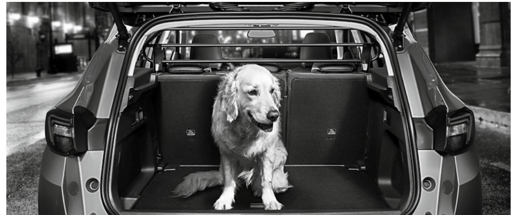
**Laderaumtrenngitter**, zur Befestigung hinter den Kopfstützen der 2. Sitzreihe
