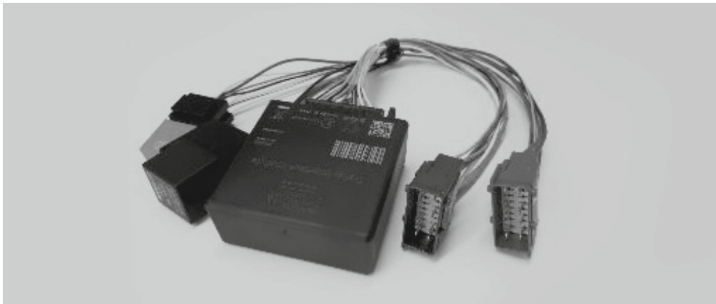
Anhängerschalteneinheit, 13 Wege (wird benötigt bei Fahrzeugen, die bereits mit einer Anhängerkupplung nachgerüstet wurden und bei denen seinerzeit noch der alte Kabelsatz 1656 244 280 verbaut wurde). Der Austausch des Moduls ermöglicht den Betrieb von Anhängern mit LED-Leuchten.
