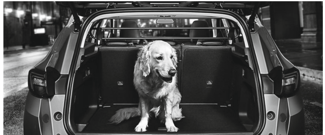
Laderaumtrenngitter , zur Befestigung hinter den Kopfstützen der 2. Sitzreihe Artikelnummer 95 599 851
